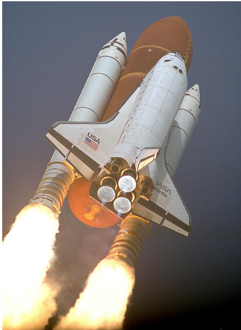
Obrázek 17.8. Pomocné startovací rakety na pevné palivo (Solid Rocket Booster)
